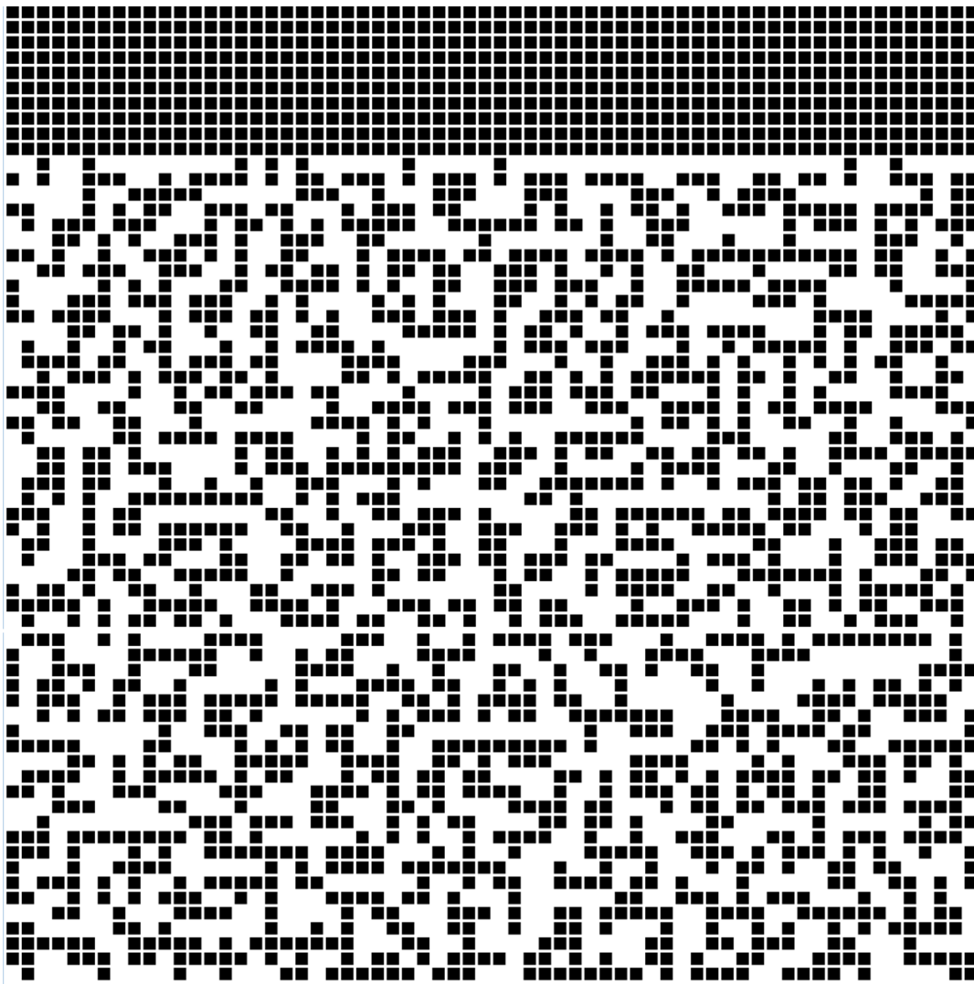
Fig.3d 縦 10×横 64 の初期条件を与えたときの従来の二次元モデルの表面形状 (従来のモデルのしきい値 Z = 20 )
